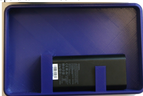
Фиг. 5. Нижняя крышка прибора с прикреплённым к ней аккумулятором.
