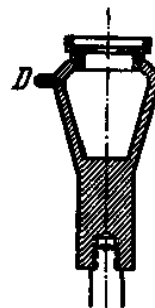
Рис. 23. Шприц для чернил, применяемый на рис. 22, в половину натуральной величины.
