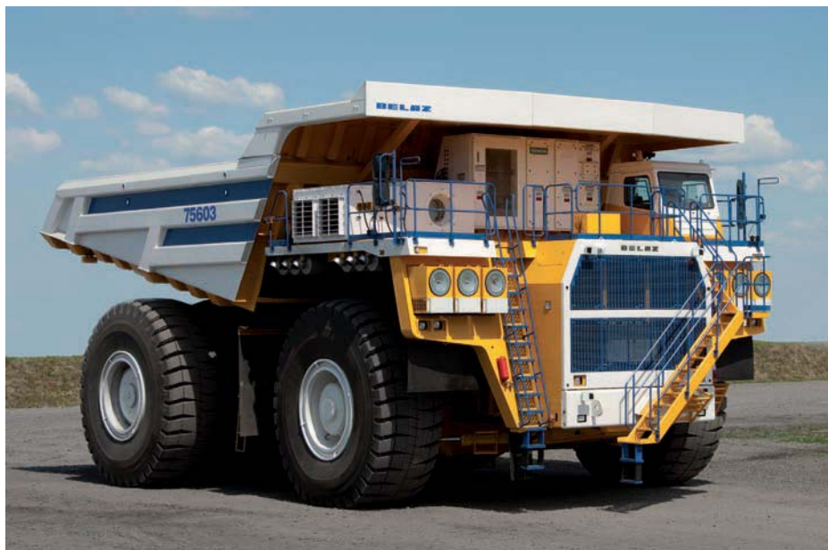
Карьерный самосвал БЕЛАЗ-75603 грузоподъемностью 360 т
