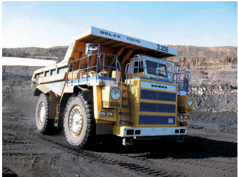
Карьерный самосвал БЕЛАЗ-75570 грузоподъемностью 90 т
