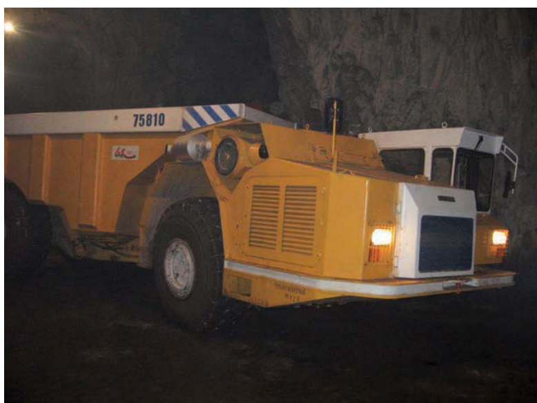
Самосвал шахтный БЕЛАЗ-75810 грузоподъемностью 50 т
